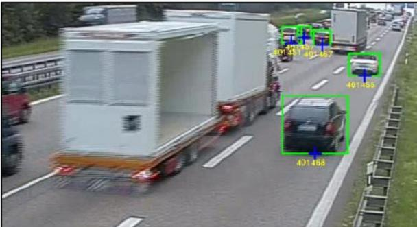
Bild 3-11: Okklusionen durch LKW können für mehrere Sekunden Messdaten verfälschen bzw. invalidieren
